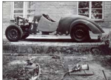
„Vysavačová“ stříkací pistole Drukofix je při správném použití plnohodnotný nástroj. Osvědčila se později při mnoha dalších renovacích
