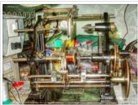
Opravná navíječka „Douglas“ ze třicátých let. Stále funkční, na občasné „domácí“ převínutí magnetky ideální
