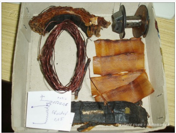
Pitva. Šelaková izolace proměněná v lepkavý šlem, celkový stav značně neuspokojivý, pacient doporučen k transplantaci vinutí
