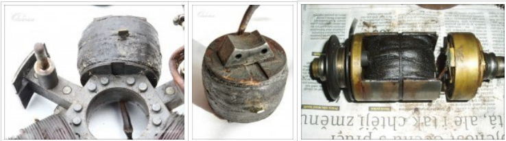
Původní setrvačnicková cívka a magdyno Bosch. Již samotný pohled na stav izolace dává tušit, že nebudou v nejlepší kondici
