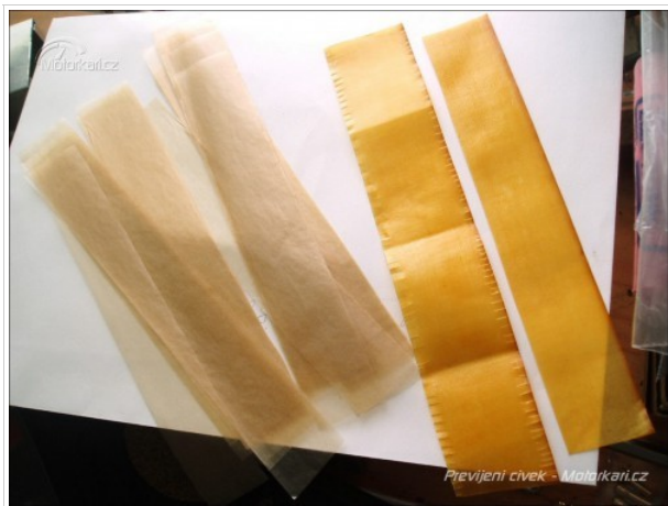
Cívka smaltovaného drátu 0,06 mm a příprava prokladů
