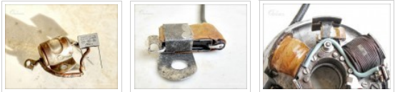
Původní kondenzátor setrvačnickového zapalování a jeho moderní náhrada
